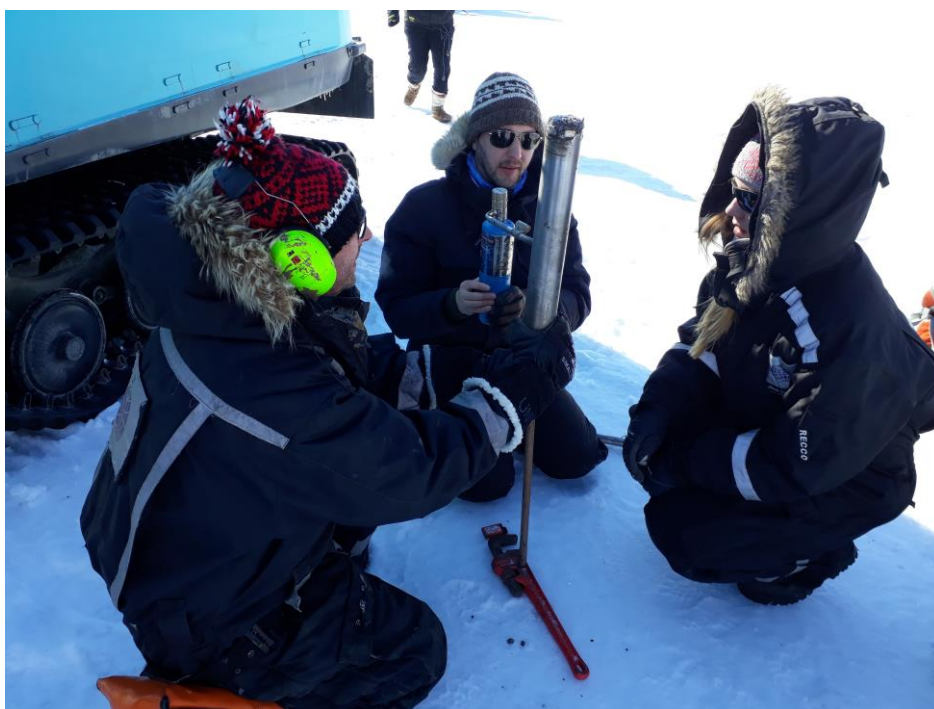
Fot. 3. Odwierty w zamrzniętym gruncie i pobieranie prób rdzeni do analiz labolatoryjnych.
