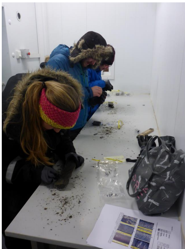
Fot. 4. Praca w tzw. zimnym labolatorium z temperaturą -6\text{ }^{\circ}\text{C} , oczyszczanie pobranych rdzeni zamrzniętego gruntu.
