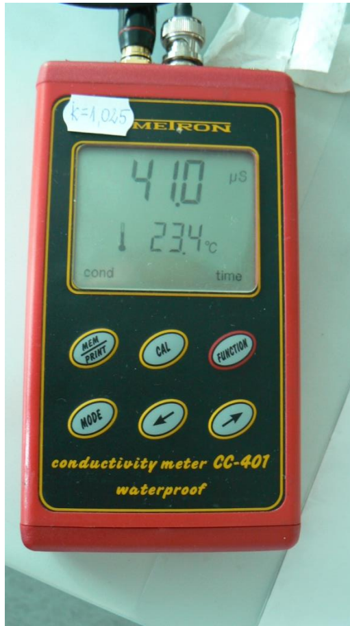
Konduktometr CC-401 polskiej firmy Elmetron, wykorzystywany podczas pomiarów laboratoryjnych
