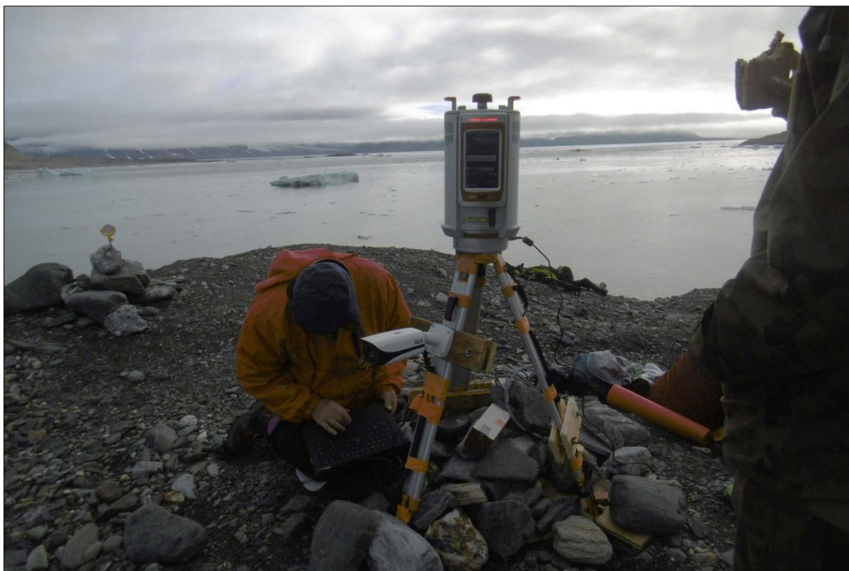
Fig. 6. Obsługa automatycznej kamery cyfrowej oraz równoczesne skanowanie laserowe klifu Lodowca Hansa (Fot. P. Waleczek).
