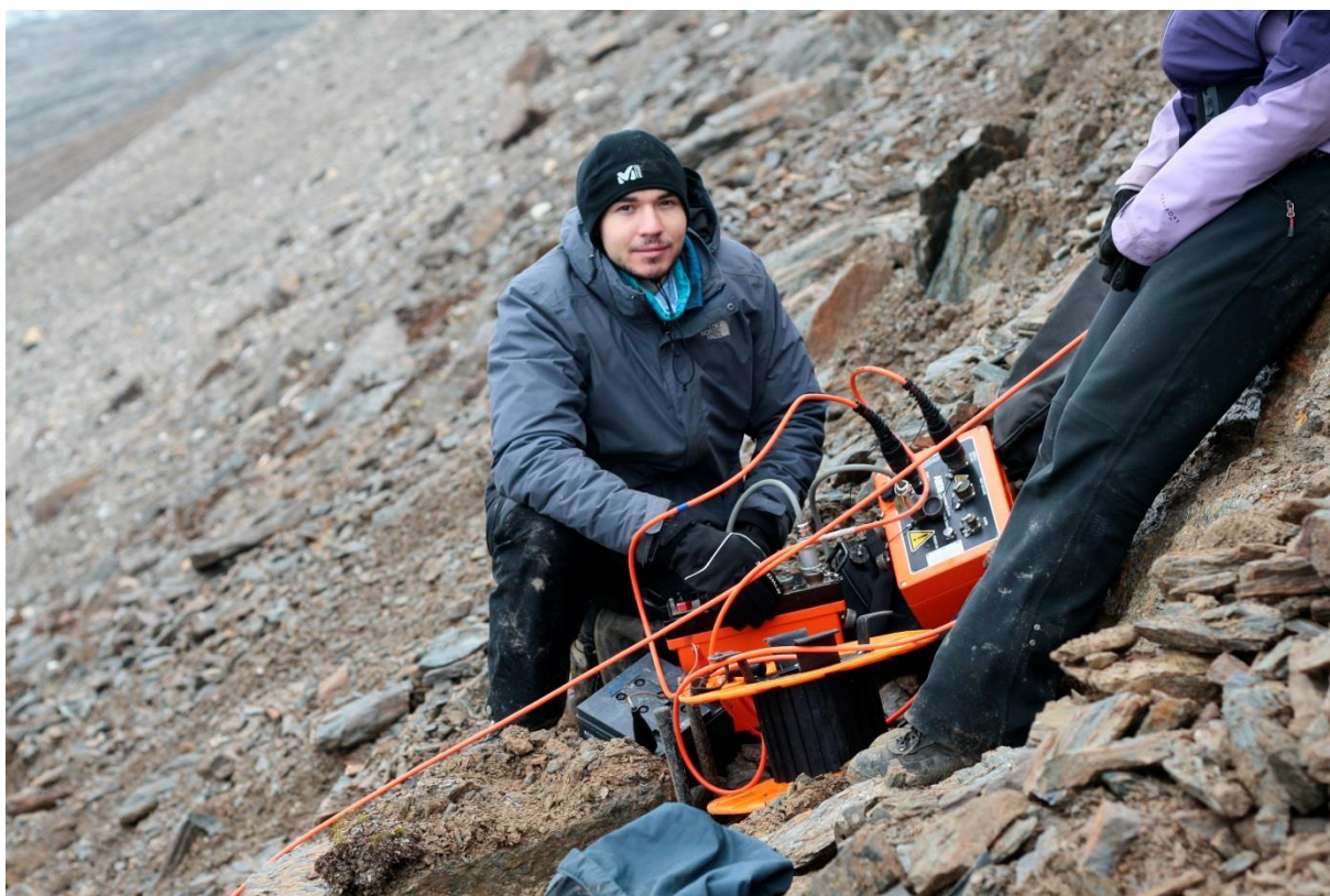
Fot. 1 Pomiar elektrooporowiy na zboczu Fugleberget.
